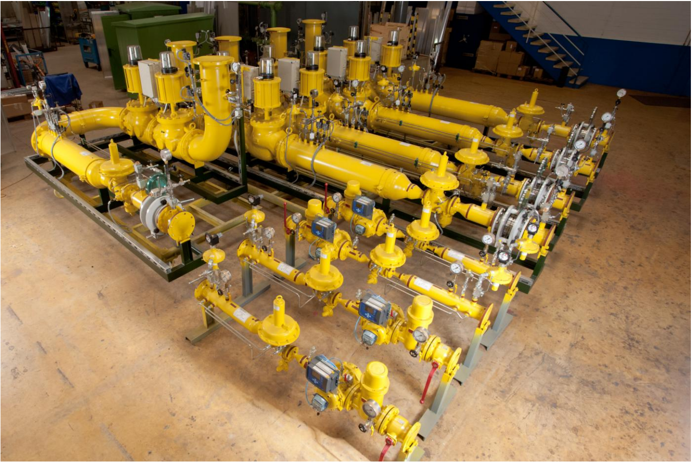
Foto: ThyssenKrupp AG - 5 Gasregelstrecken im Werk Ettlingen betriebsfertig vor Auslieferung
