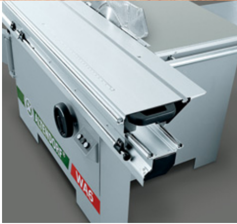
Der bewährte Altendorf Doppelrollwagen mit Stahlführung.
