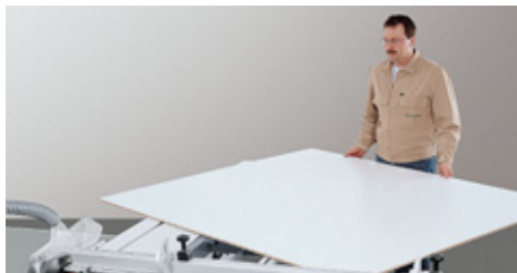
Die Platte entgegen dem Uhrzeigersinn drehen und besäumte Kante am Winkelanschlag anlegen.
