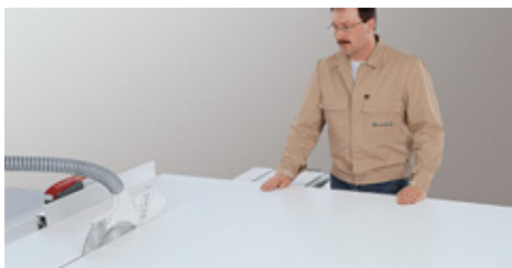
Plattenstreifen am Parallelanschlag aufschneiden.
