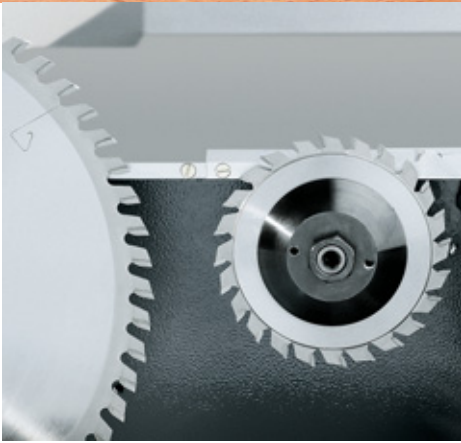
Vorritzer. Separater Vorritzermotor mit 0,37 kW und Ein/Aus-Schalter.
