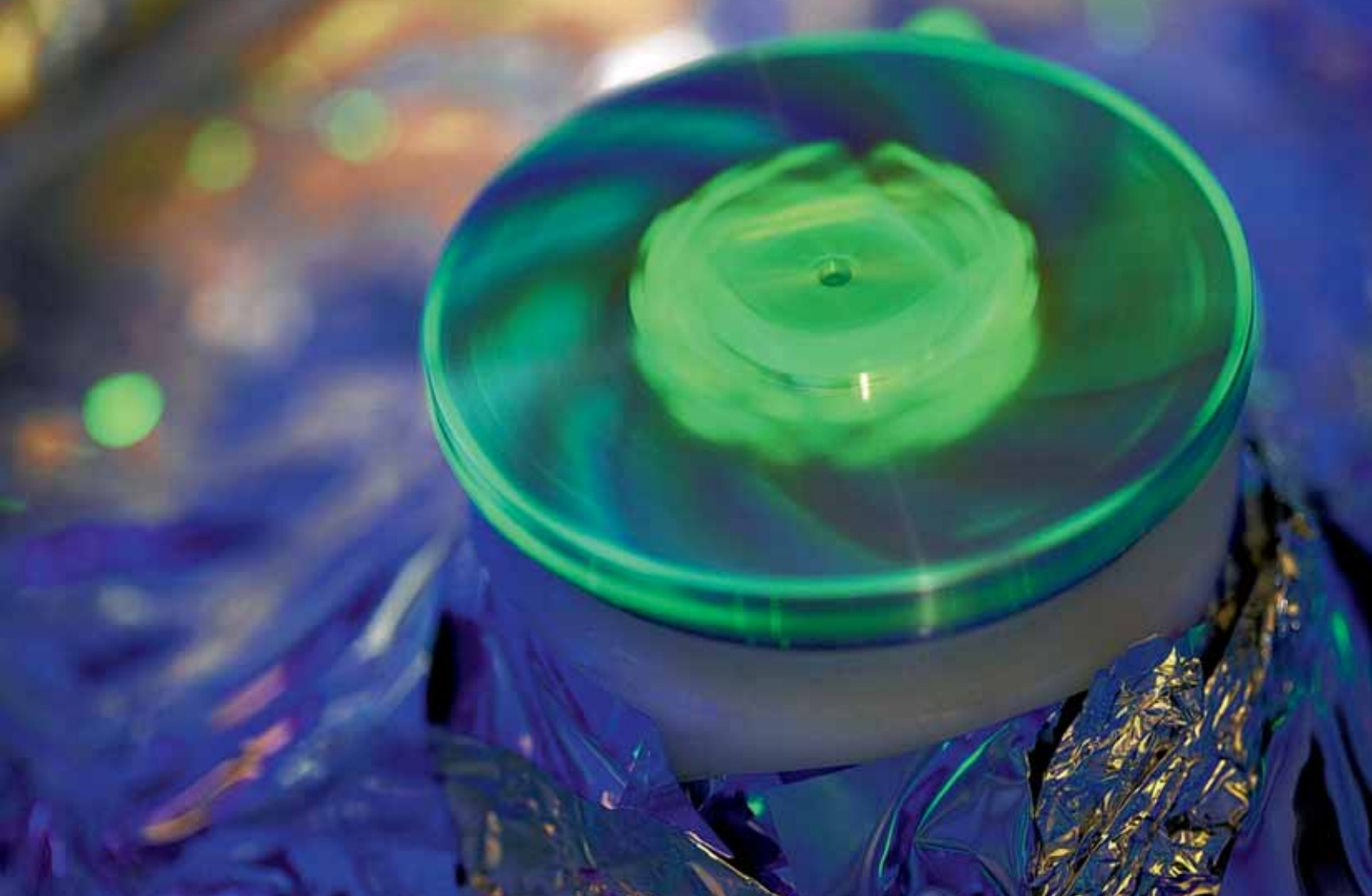
Solarzellentechnologie auf Basis organischer Materialien: Ein Glassubstrat wird mit bis zu 6000 Umdrehungen in der Minute durch Spincoating beschichtet. Bei diesem Vorgang wird das Substrat mit einem für die Farbstoffsolarzelle geeigneten Materialfilm überzogen, der wenige Nanometer dünn ist. Bild: BASF
