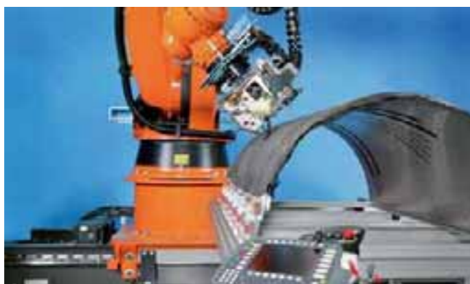
Eine Nähmaschine der KSL Keilmann Sondermaschinen GmbH. Die Firma baut und entwickelt Anlagen, die „biegeschlaffe Materialien“ verarbeiten. Bild: KSL
